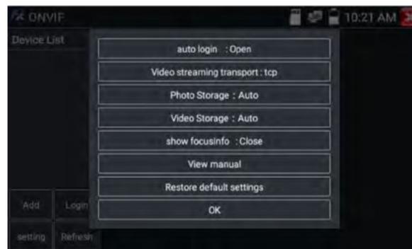
**Accesso automatico:** Dopo aver aperto questa funzione, il tester può effettuare l'accesso automatico alla telecamera e visualizzare l'immagine della telecamera (la password di accesso è la stessa dell'ultima volta, la prima volta che si utilizza la password è la password predefinita "admin").
