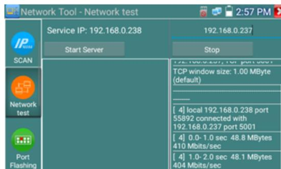
Oppure utilizzare il tester come server e il computer come client di prova (selezionare Client, inserire l'indirizzo IP del tester per eseguire il test).
