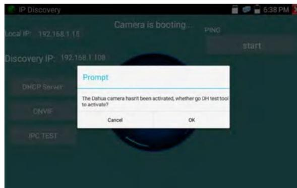
**IP locale:** indirizzo IP del tester, lo strumento può modificare automaticamente l'IP del tester sullo stesso segmento di rete con l'IP della telecamera scansionata.
