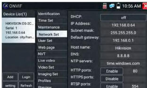
**Impostazione immagine:** Fare clic su "Imaging Set" per regolare la luminosità, la saturazione, il contrasto, la nitidezza e la modalità di compensazione del controllo luce dell'immagine.
