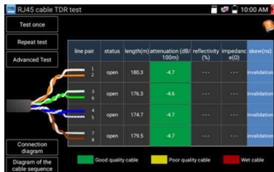
**Test singolo:** Verifica lo stato del cavo, la lunghezza e l'attenuazione.
