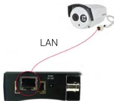
**Nota:** se la telecamera IP richiede l'alimentazione PoE, collegare la telecamera IP alla porta LAN del tester IP. Il tester fornirà l'alimentazione PoE alla telecamera IP. Fare clic sull'icona POE per disattivare o attivare l'alimentazione PoE.
