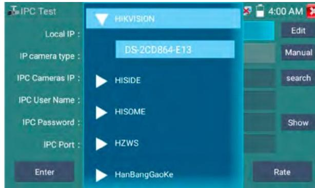
**Codice flusso:** quando si testa la telecamera tramite RTSP, è possibile selezionare il flusso principale o secondario da testare (se l'RTSP della telecamera non è stato avviato o non è stato avviato, verrà visualizzato il messaggio "auto match fail, please witch to manually selecting").
