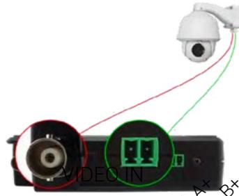
1) Collegare l'uscita video della telecamera CVI all'interfaccia "Video IN" del tester IP; l'immagine verrà visualizzata sul tester. Il tester è dotato solo di un'interfaccia di ingresso CVI. Non esiste un'interfaccia di uscita CVI.
