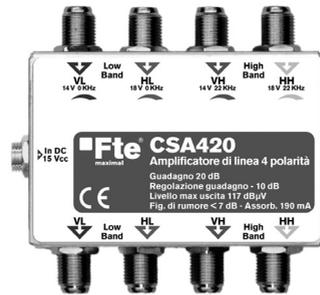
È un amplificatore di linea con guadagno da 20 dB e 30 dB con livello di uscita di 117 dBμV e regolazione di guadagno per ogni polarità. L'amplificatore CSA420 viene alimentato direttamente con alimentatore esterno tramite la presa a lato dell'amplificatore o tramite iniettore di corrente IN1218.
