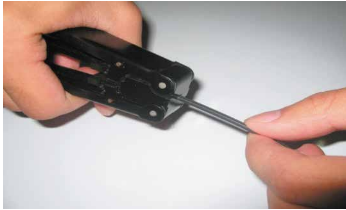
Figura 2-6 Spellatura Fibra Butterfield
