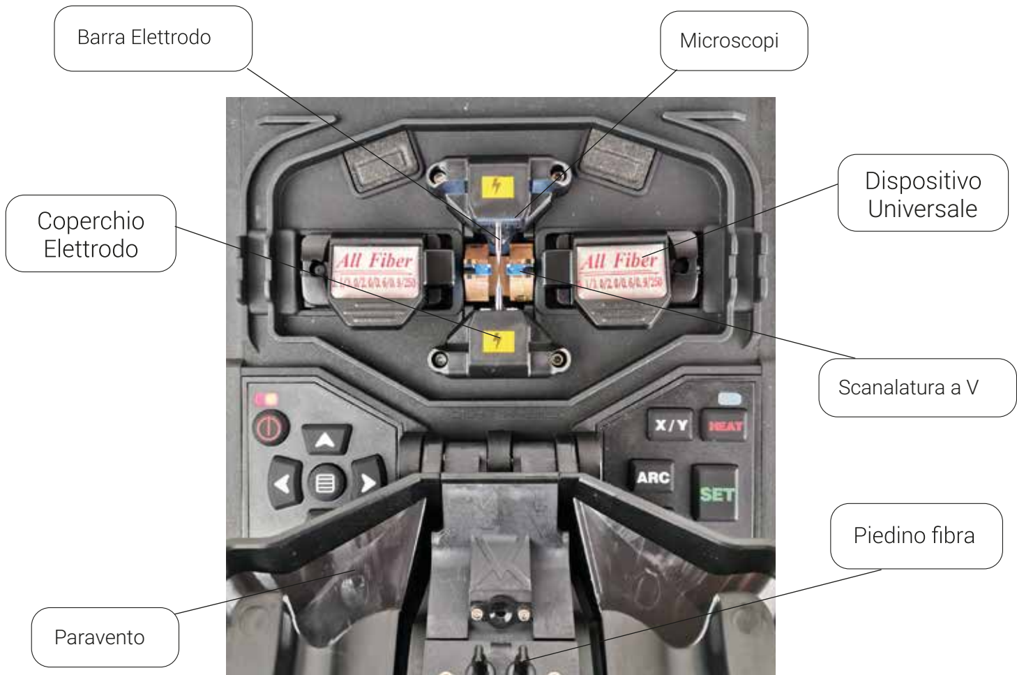
Figura 1-3 Struttura Giuntatrice a Fusione per Fibra Ottica
