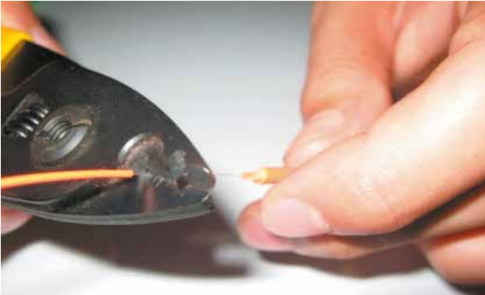
(c) Spellare lo strato di plastica interno con delle pinze Miller
