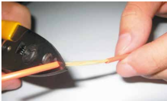
a) Spellare lo strato di plastica esterno con delle pinze Miller
