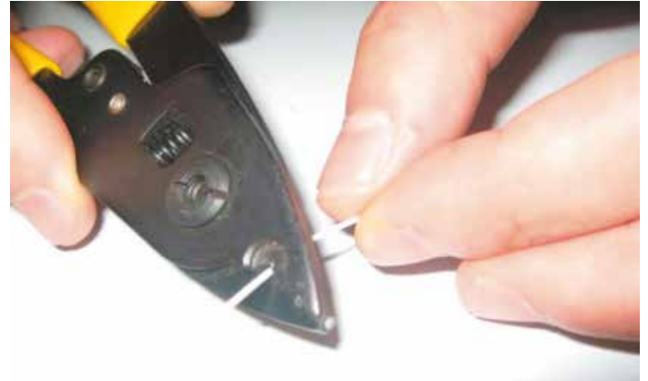
(d) Spellare l'unico strato di plastica con delle pinze Miller
