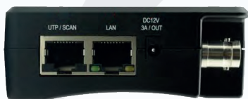
Vista laterale con porta RJ45, output PoE e output alimentazione 12V/3A
